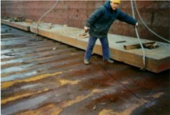
Abb. 1-5: Wellen im Innenboden Fig. 1-5: Corrugations in the inner bottom
