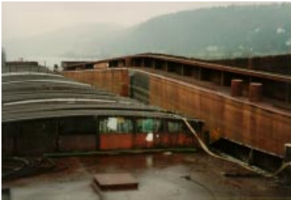
Abb. 1-7: Aufbiegung eines Schubleichters (1)
