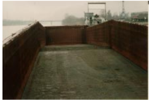
Abb. 1-8: Aufbiegung eines Schubleichters (2)
