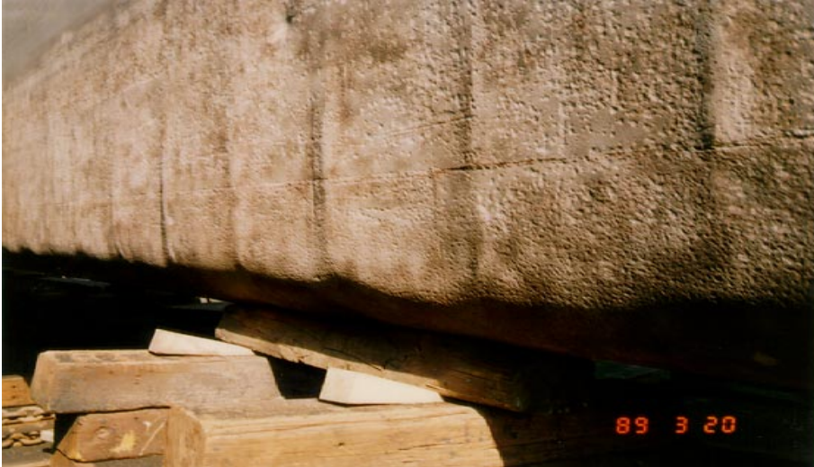
Abb. 1-10: "Hungerfalten" in der Kimmbeplattung und Korrosionsschäden
